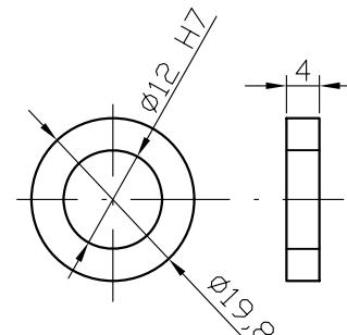
Náboj - ocel (tř. 11700). Otvor vystružený - prům. 12 H7. Osy otvorů pro upevňovací šrouby a patřičné zfréfování přizpůsobit dle vlastního stroje - nemusí to sedět.
